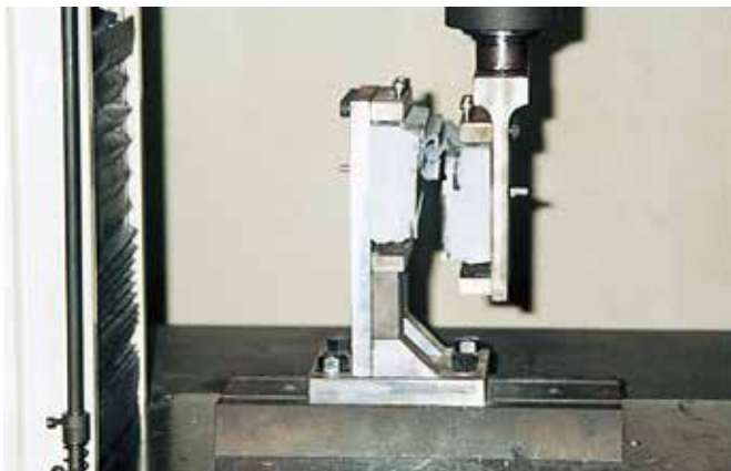
▲鉛直せん断試験状況
