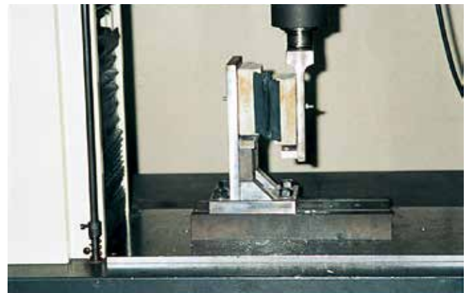
▲水平せん断試験状況
