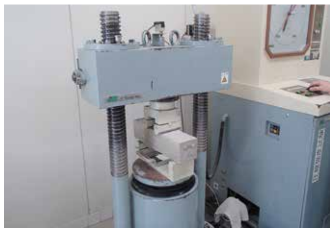
▲曲げ载荷試験状況
