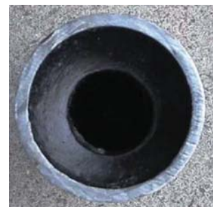
▲専用充填材の充填状況
